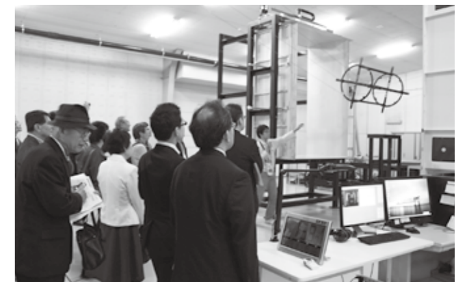
風速10メートルで送電線の模型を揺らす
