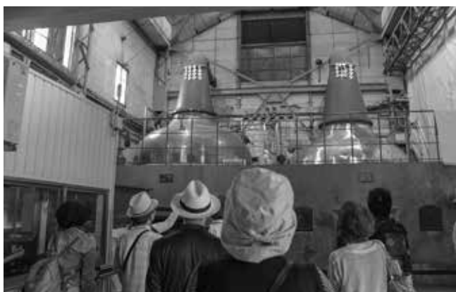
世界で唯一石炭直火蒸溜が採用されている単式蒸溜器
