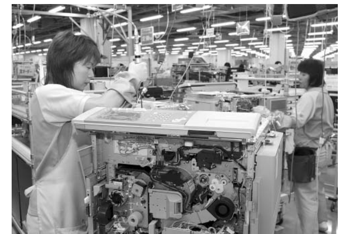
セル生産方式で複写機を製造する様子 写真提供 キヤノン(株)
