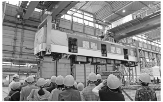
台車と切り離れた車体をクレーンで運搬する様子
