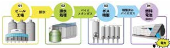
ビール工場排水由来のバイオガスを利用した燃料電池による発電工程
