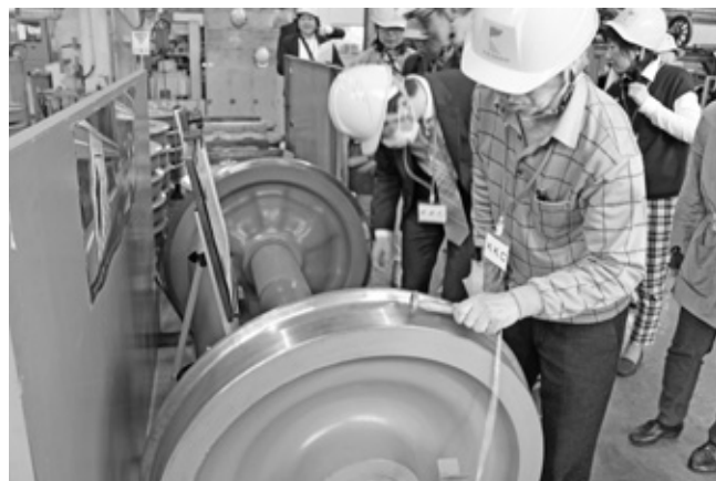
ハンマーを用いて防音車輪の性能を体感する参加者
